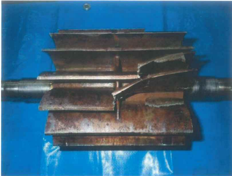
須古地区水処理センター No.1真空ポンプ分解整備
